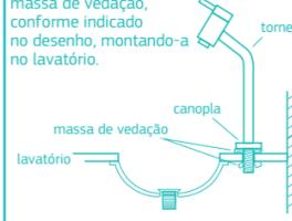
Coloque a porca arruela, apertando-a firmemente, com o auxílio de uma ferramenta. A torneira deverá ser conectada ao ponto de saída de água através de uma ligação flexível, preferencialmente Deca, que contém em sua embalagem as informações necessárias para sua instalação.
